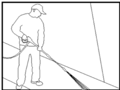
Рис. 6 - Оптимальный угол распыления воды относительно поверхности
